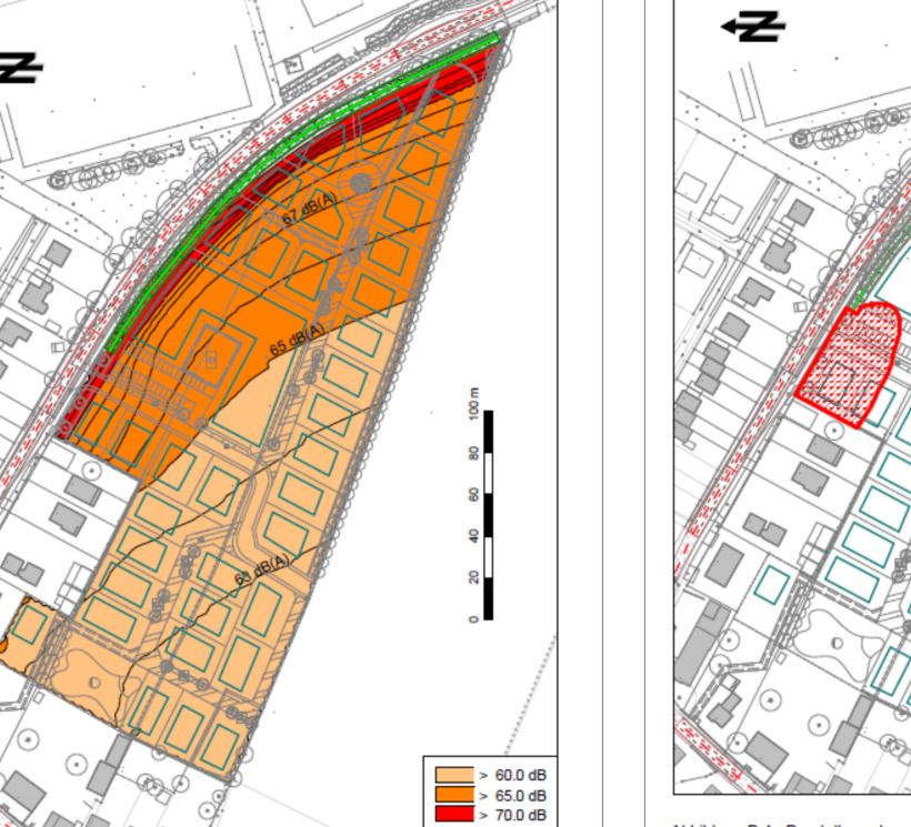
Abbildung B 4: Darstellung der geschlossen auszuführenden Außenwohnbereiche in de Obergeschossen, Maßstab 1:2.000
