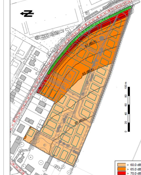
Zur Errichtung, Änderung oder Nutzungsänderung des Gebäudes in den nicht nur vorübergehend zum Aufenthalt von Menschen vorgesehenen Räumen sind die Anforderungen an das resultierende Schalldämm-Maß für das jeweilige Außenbauteil (einschließlich aller Einbauten) gemäß DIN 4109 (Januar 2018) zu ermitteln. Im Rahmen der jeweiligen Baugenehmigungsverfahren ist die Eignung der für die Außenbauteile der Gebäude gewählten Konstruktionen nach den Kriterien der DIN 4109 (Januar 2018) nachzuweisen.
