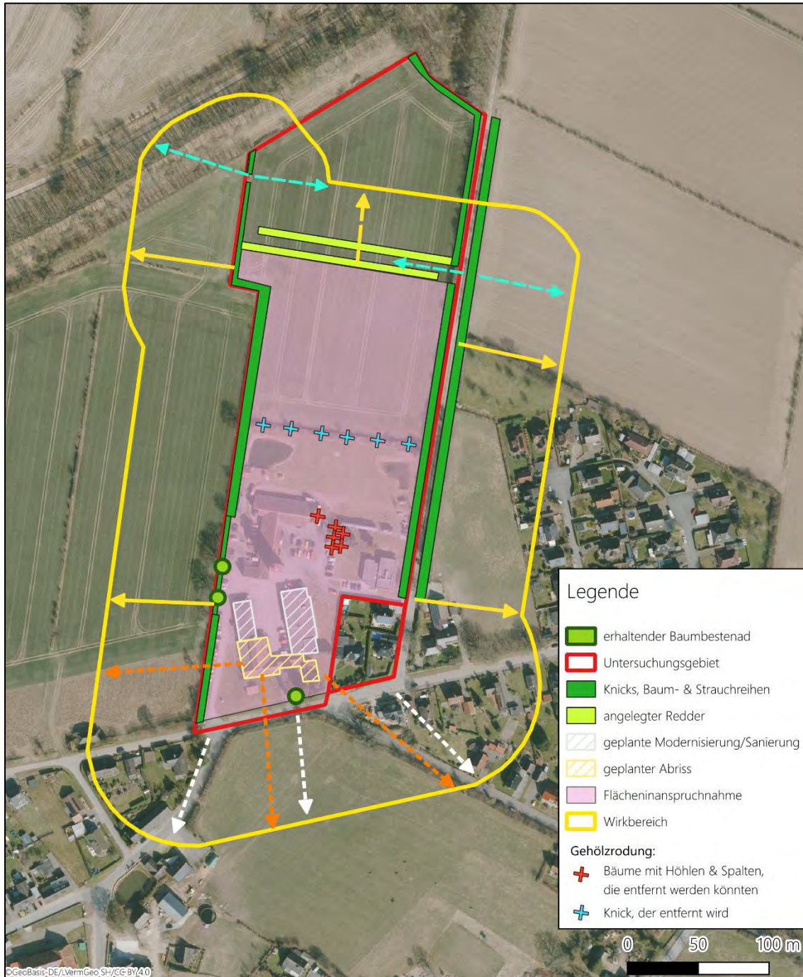
Abbildung 3: Betrachtungsraum und Abgrenzung des maximalen Wirkraums gelbe Pfeile = Indirekte Störwirkungen (Lärm, Licht, Bewegung, Staub) orange Pfeile = temporäre Störung - Abrissarbeiten blaue Pfeile = temporäre Störung - Knickdurchbruch weiße Pfeile = abgeschwächte Störwirkung - Straße
